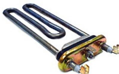
Ce thermoplongeur est placé en bas de la cuve de façon à être toujours immergé ; il est maintenu dans son logement par une bride ou un support en acier inoxydable. Un joint compressible assure l'étanchéité de l'orifice du logement.
